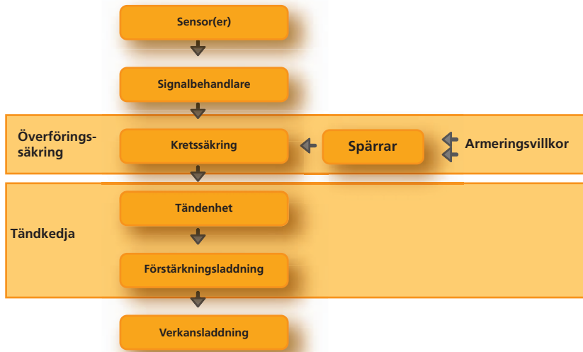
Bild 4:17 Tändsystem med obruten tändkedja ("in-line")
