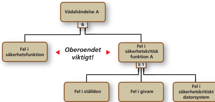
Bild 4:10 Reducerat generiskt felträd, en-kanaligt säkerhetskritiskt system
