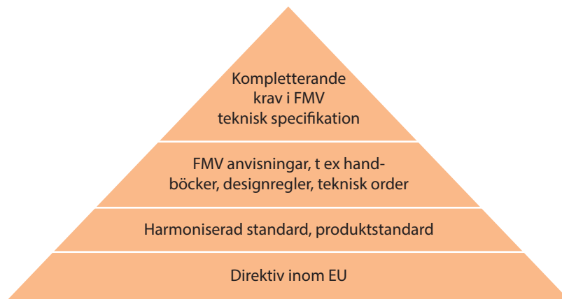
Bild 7:2. Principbild för elsäkerhetskrav i teknisk specifikation.
