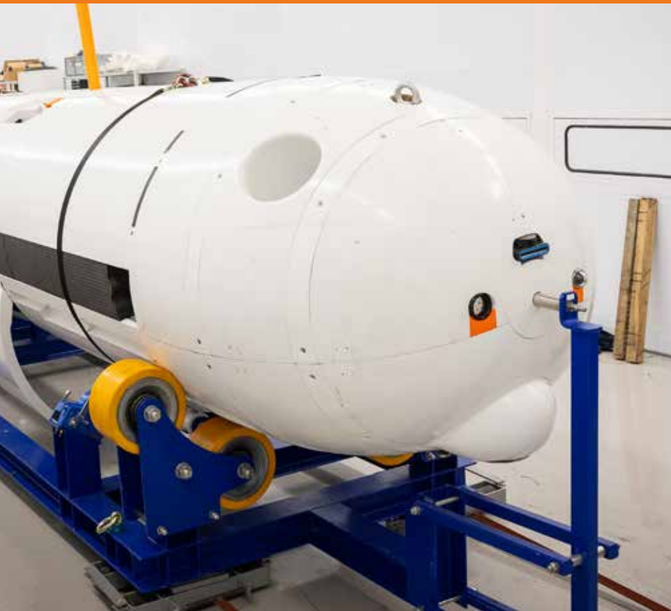
I fören sitter en aktiv sonar, en kamera, ett LED-ljus och en så kallad doppler som används för navigering och positionering.
