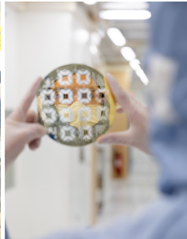
Den etsade skivan innehåller delar av en millilitervägsantenn till Terasis radioenhet.
